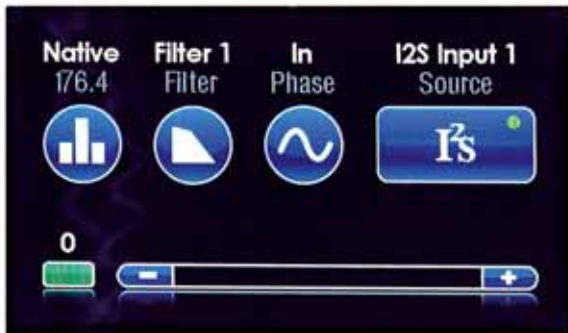
Der Standard-Bildschirm des PWD. Hier kann man den Eingang wählen, die Lautstärke einstellen, Absolutphase, Digitalfilter und Upsampling einstellen
