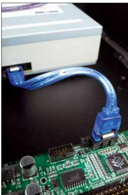
Das Computer-DVD-Laufwerk dockt via SATA-Kabel an die Ausleseelektronik an
